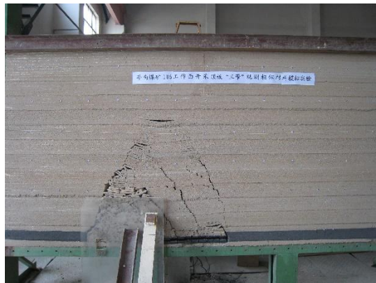
开挖 144m 时，覆岩垮落形态图
