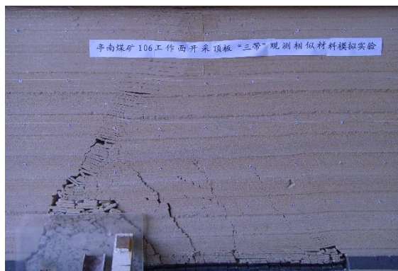
开挖 202m 时，覆岩垮落形态图
