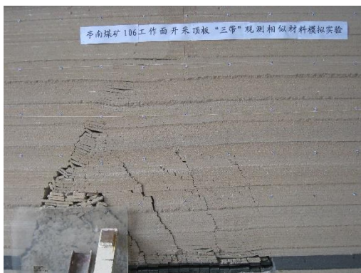
开挖 172m 时，覆岩垮落形态图
