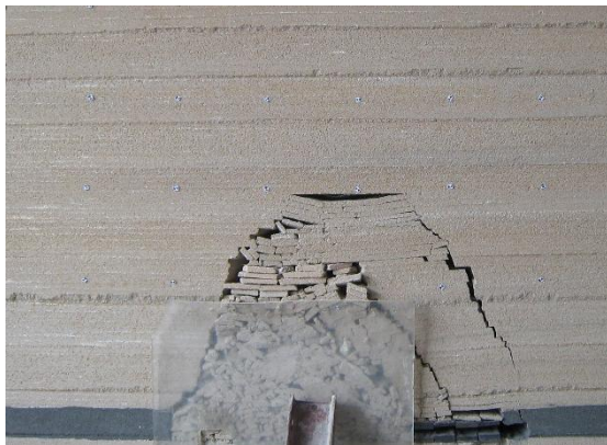
开挖 114m 时，覆岩垮落形态图
