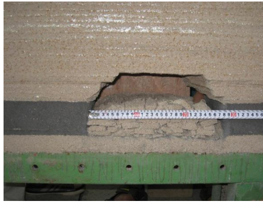
开挖 45m 时，覆岩垮落形态图
