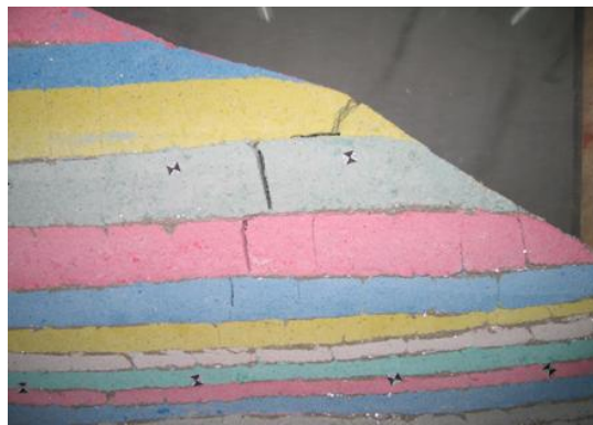
左侧山体裂缝
