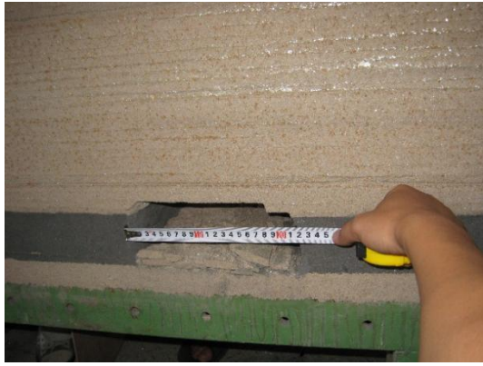
开挖 30m 时，覆岩垮落形态图
